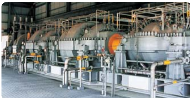
エチレンプラント用分解ガスコンプレッサ・蒸気タービン
