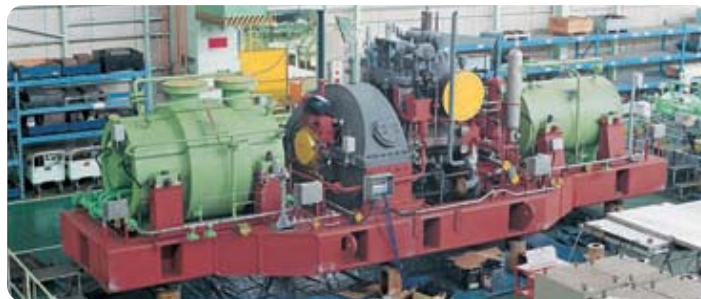
高圧合成ガスコンプレッサ・蒸気タービン
